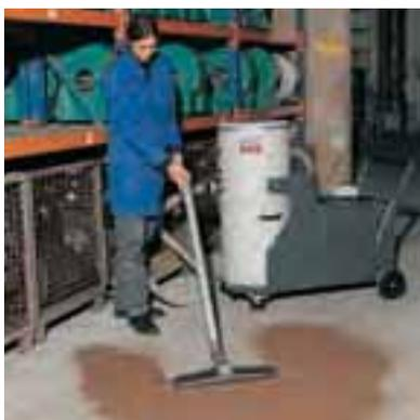
Zur Absaugung von Metallspänen und emulsionsbehafteten Spänen wird der SPÄNESOG eingesetzt. Die MULTISOG Modelle können als Nass- und Trockensauger eingesetzt werden. Das Sortiment wird durch die handlichen Industriesauger PRETTYBOY 309 und ESTA OFENSAUGER abgerundet.
