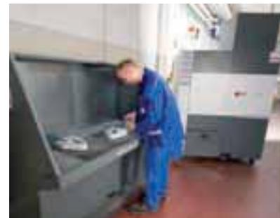
Die MOBEX kann auch in Kombination mit einem ESTA Schleiftisch zur Absaugung von Stäuben eingesetzt werden.
