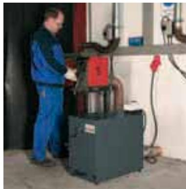
Kleinentstauber TK an einer Entgratmaschine
