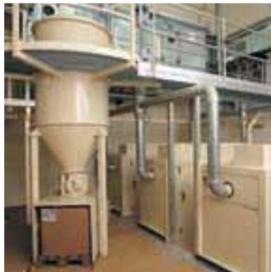
Filtersystem mit Staubaustrag über Zellschleuse und parallel geschalteten Drehkolbengebläsen
