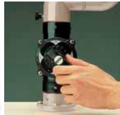
Luftstromdrosselventil zur Regulierung der Saugkraft
