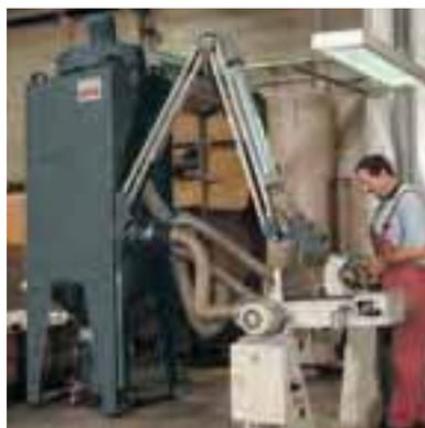
NA-K an einer Schleifbandmaschine
