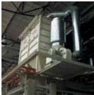
Schlauchfiltereinheit mit nebenstehendem Ventilator
