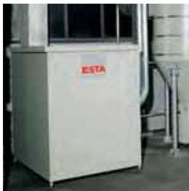
Hochdruck-Ventilator in Verbindung mit einem ESTA-Filterzyklon
