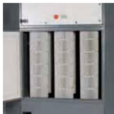
Die großflächige Tür erlaubt einen optimalen Zugang in den Filterraum.
