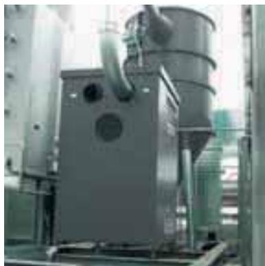
Filtereinheit mit Explosionsschutz
