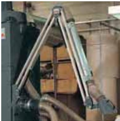
Die stärkste Absauganlage mit den besten Filtern nützt nichts, wenn die staubhaltige Luft nicht ins Gerät gelangt. Dafür sorgen oftmals flexible Absaugarme, die punktgenau an die Staubquelle hingeführt werden und den gesamten Streubereich abdecken können.
