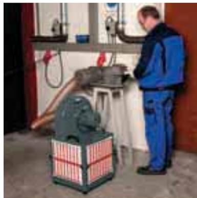
ESTA 100 an einer Bandschleifmaschine
