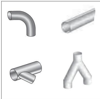
Formteile aus Stahlrohr
