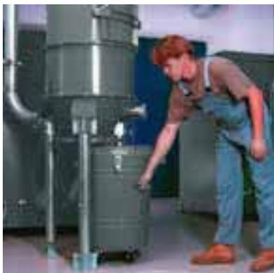
Der fahrbare Staubsammelbehälter mit eingelegtem Plastiksack ermöglicht die leichte und staubfreie Entsorgung des abgesaugten Schmutzes.
