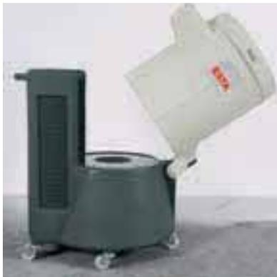
Beim Schweißen entsteht gesundheitsgefährdender Rauch. Dieser Schweißrauch kann durch einen Schweißrauchfilter entweder direkt über eine Düse oder über eine Absaughaube erfasst und gefiltert werden. Die filtrierte Luft wird danach in den Arbeitsraum zurückgeführt oder über eine Rohrleitung ins Freie geleitet.
