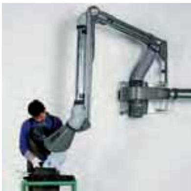
Absauggebläse in Verbindung mit ESTA Absaugarmen sind eine kostengünstige und effektive Art der Absaugung. Der Staub oder Rauch wird mittels eines Gebläses über den Absaugarm abgesaugt und ohne Filtrierung in den gewünschten Bereich (i. d. R. ins Freie) geleitet. Sinn und Zweck ist es, die Abluft an einen anderen Ort innerhalb oder außerhalb des Gebäudes zu transportieren.
