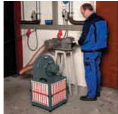
ESTA 100 an einer Bandschleifmaschine
