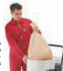
Einfaches Entsorgen des Staubsammelgutes mittels Papierfilter.
