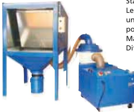
DUSTOMAT 160-S in OEM-Version zur Absaugung an einer Handbeflockungskabine
