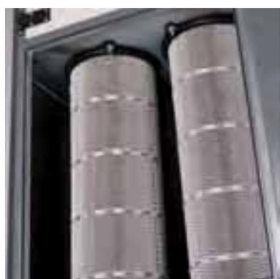
Die hochwertigen Filterpatronen der Staubklasse „M“ sind speziell für die Abscheidung von Schweißpartikeln ausgelegt.
