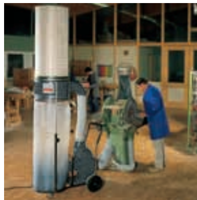
Fahrbare Absaugung mit Filterpatrone
