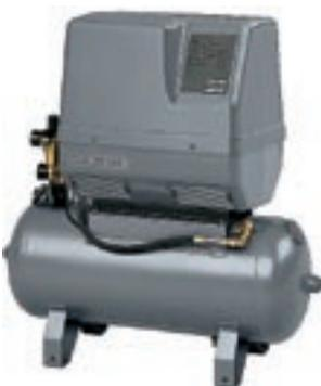
Kompressoraggregat montiert auf einem innen mit Epoxy beschichteten 50- oder 100-Liter-Luftbehälter, einschließlich Regelung, Sicherheitsventil, Druckregler, Auslassventil und Manometer. Die komplette schallgedämpfte Druckluftanlage. Bei 60-Hz-Aggregaten sind die Behälter standardmäßig nach ASME zugelassen. Bei 50-Hz-Aggregaten sind die Behälter nach CE/AS1210 (nur 50 l) zugelassen.
