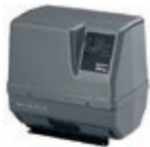
Komplett schallgedämpftes, in sich geschlossenes einzylindriges Kompressor-Motorpaket mit thermischem Elektromotorschutz bei einphasigen Aggregaten. Das Aggregat dient als komplettes Austauschpaket für behältermontierte Einheiten oder für spezielle Erstausrüsteranwendungen. (Option: Auslassventil, einschließlich Regler, Manometer)
