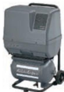
Kompressoraggregat montiert auf einem innen mit Epoxy beschichteten 20-Liter-Luftbehälter (CE/AS1210 für 50 Hz, ASME für 60 Hz), einschließlich Regelung, Sicherheitsventil, Druckregler, geregelter Auslassventil, Manometer und fahrbarem Rahmen. Bei 3-Phasen-Aggregaten ist ein Überlastschutz vorhanden. Eine komplett schallgedämpfte und mobile ölfreie Kompressoranlage.
