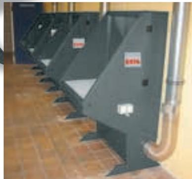
Mehrere ESTA Schweißische sind an einer Absaug-/Filteranlage angeschlossen
