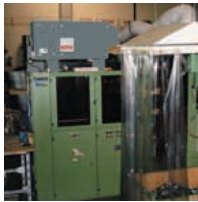
Ölnebelabscheider in der Anwendung
