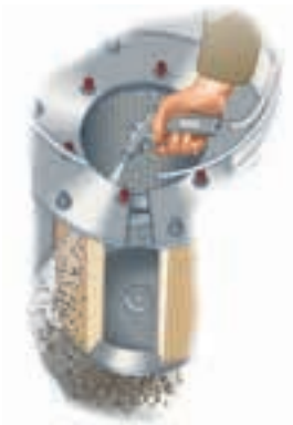
Abreinigung mit Druckluft
