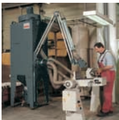
Nassabscheider NA-K beim Absaugen von Aluminiumstäuben
