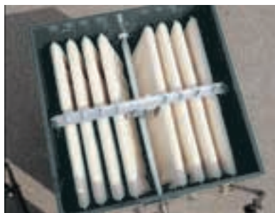
Die Taschenfilter aus Baumwolle (Standard) mit mechanischer Abklopfvorrichtung
