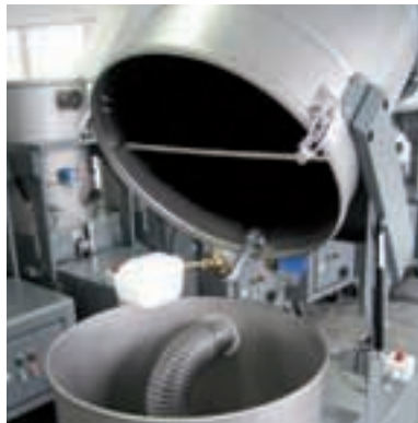
Abkipbares Geräteoberteil für leichten Zugang ins Innere
