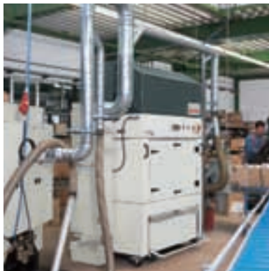
Kompaktentstauber COMPEX in der Schuhindustrie
