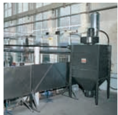
Modularer Entstauber DUSTEX in der Metallverarbeitung
