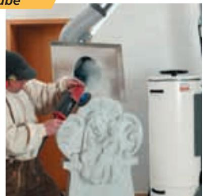
DUSTOMAT-16 M – direkte Absaugung des feinen Steinstaubes
