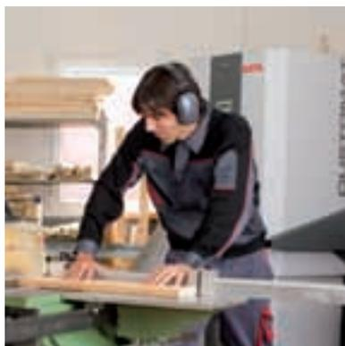
DUSTOMAT P-20 an einer Kreissäge
